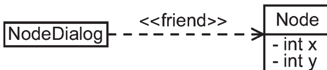
Класс NodeDialog является другом класса Node и поэтому имеет доступ к переменным x и y.
